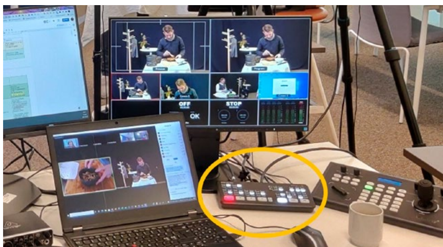
Bild 8. Producentens bord med videomixern i mitten och "multiview" från mixern på skärmen.
